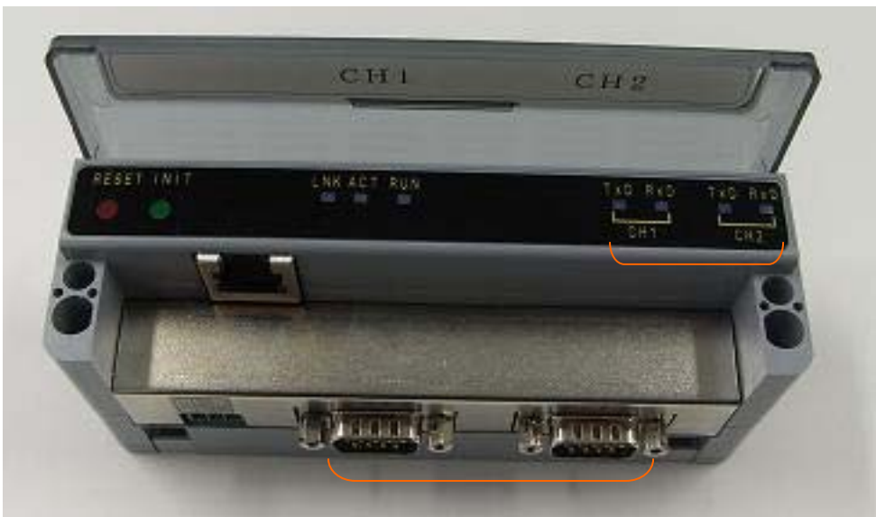
【RS-232C/LAN コンバータ正面概観図】
